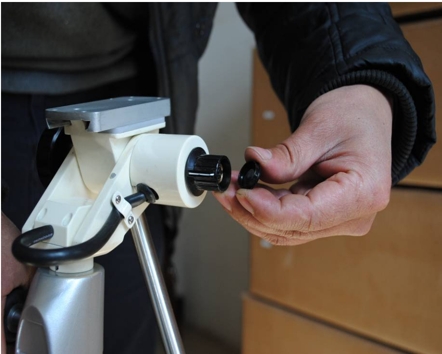
第二步：把电位器盖打开，并用尖嘴钳把电位器拆下。(0815-0825)
