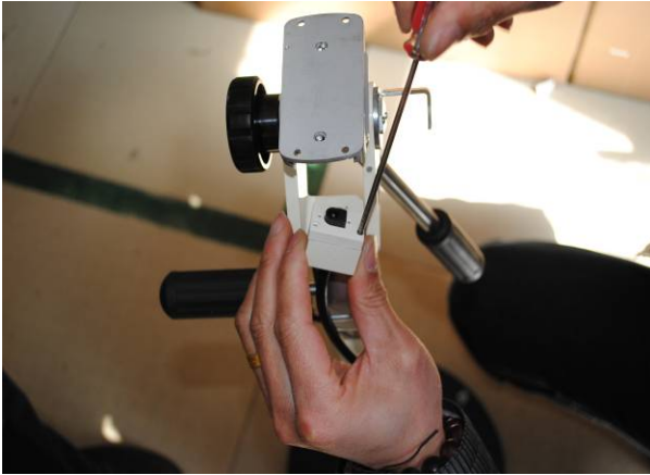
第五步：电线脱焊。（0831-0832. 这里要注意必须按照原来电线的焊接位置，以免安装时出错）
