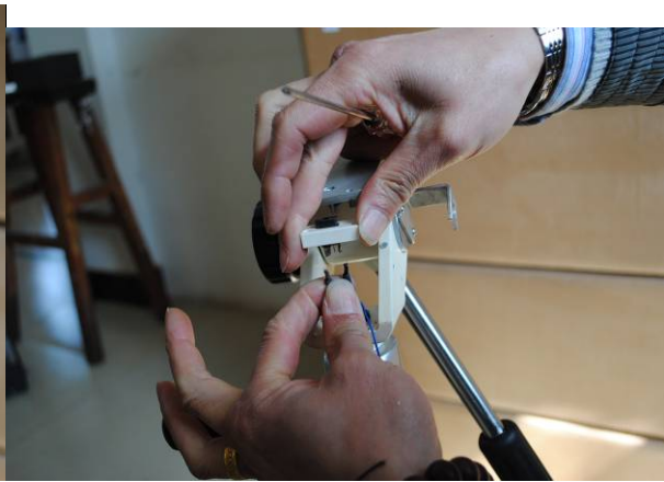
第五步：电线脱焊。（0831-0832. 这里要注意必须按照原来电线的焊接位置，以免安装时出错）
