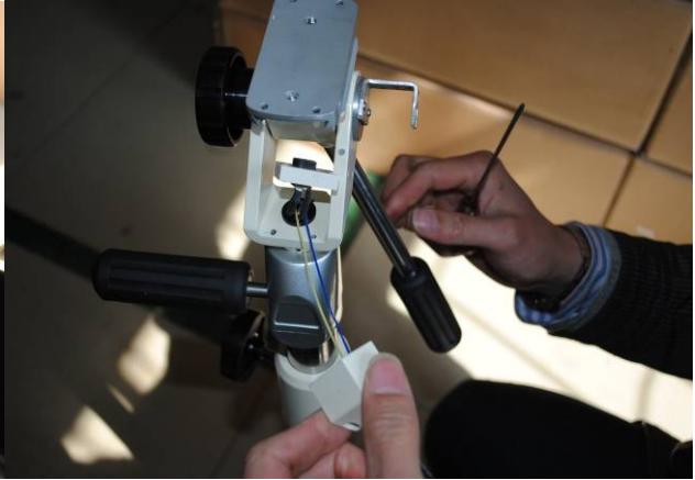
第五步：电线脱焊。（0831-0832. 这里要注意必须按照原来电线的焊接位置，以免安装时出错）
